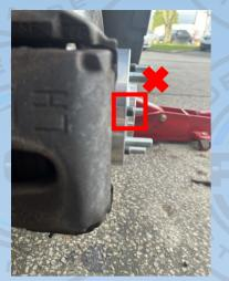
ENSURE THE WHEEL SITS FLUSH/FLAT AGAINST THE SPACER/ ADAPTER. IF THEY ARE NOT SITTING FLUSH, REMOVE THEM AND DO NOT MOUNT THE WHEEL.
